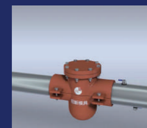
8. 不斷水施工完成
