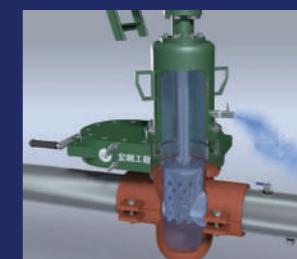
3. 開孔機進行斷管作業
