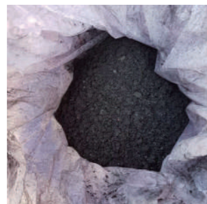
除焦作業- 清出之結焦物
