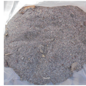
石化廠 8" 新管清出堆積物
