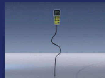
1. 管線測厚作業
