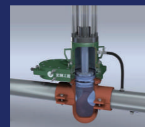
6. 執行下堵作業
